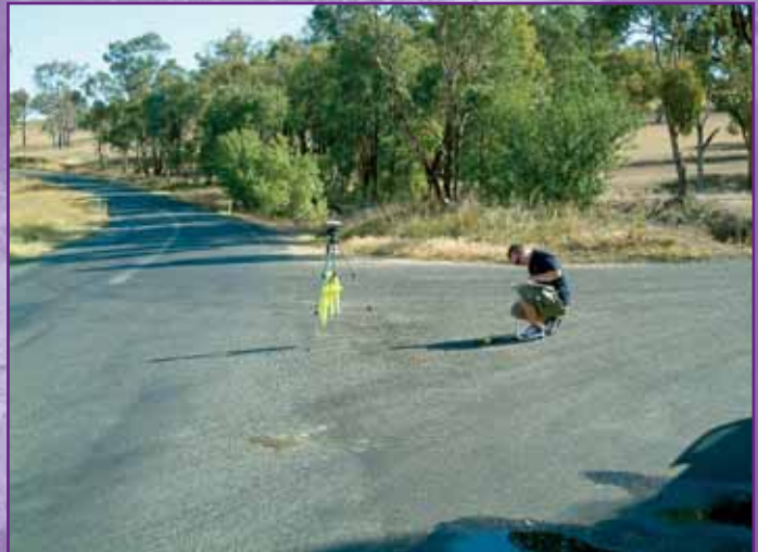
Рис. 6. Фотография наземной опорной точки № 15
