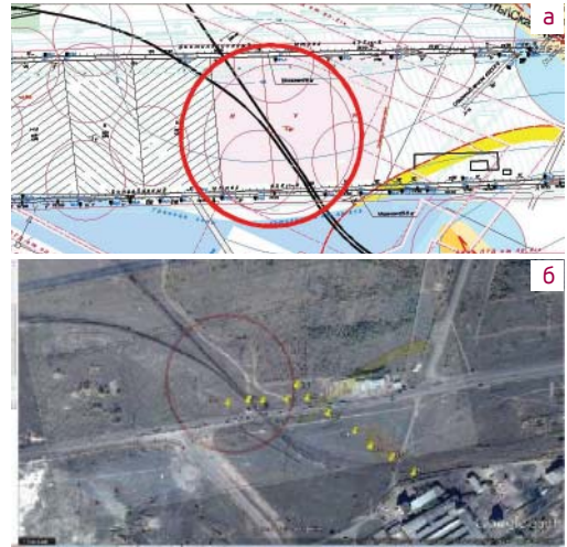
Рис. 11. Определение границ выработанного пространства и трансформирование плана добычи в Google Maps
