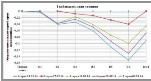
Рис. 12. Графики оседаний земной поверхности по профильным линиям по результатам нивелирования
