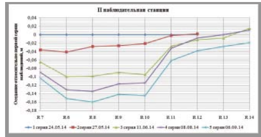
Рис. 12. Графики оседаний земной поверхности по профильным линиям по результатам нивелирования
