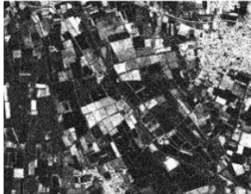
Рис. 5. Карта когерентности, рассчитанная для интерферометрической пары снимков COSMO-SkyMed, сделанных в режиме Spotlight-2 (разрешение 1 м). Темные участки — низкая когерентность, характеризующая наличие изменений за период между съемками, либо некогерентные поверхности (вода, растительность и т.п.). Светлые участки — высокая когерентность, характеризующая отсутствие изменений либо объекты со стабильной во времени фазой (территории без растительности, без воды, здания и сооружения)
