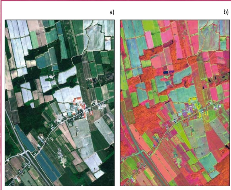
Рис. 6. а) нормальный цветовой композит; б) цветовой композит каналов ближний ИК-2, красный и зеленый после декорреляции
