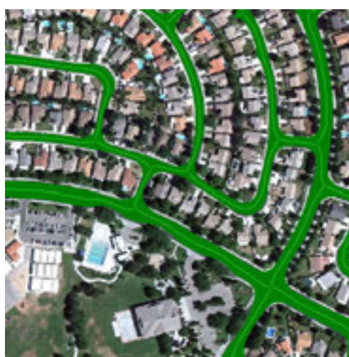
Рис. 5. Результат преобразования растра в линии после сглаживания краев
