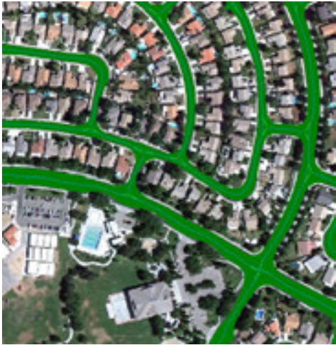
Рис. 6. Результат шивки линий на перекрестках
