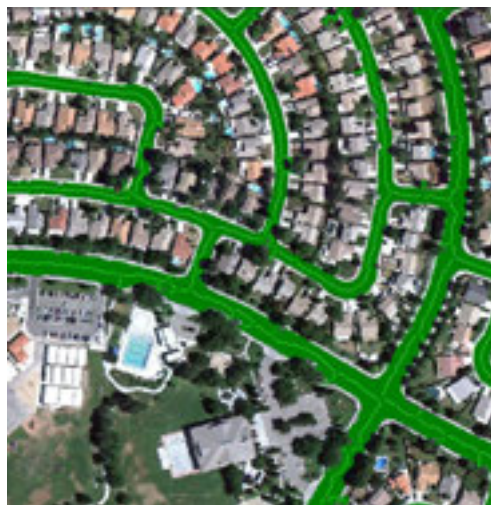
Рис. 4. Результат преобразования растра в линии без сглаживания краев
