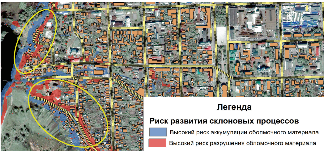
Рис. 1. Моделирование риска развития склоновых процессов в пределах городской территории (желтыми овалами обозначены жилые здания в зонах с высоким риском развития склоновых процессов) на примере г. Борисоглебска Воронежской области
