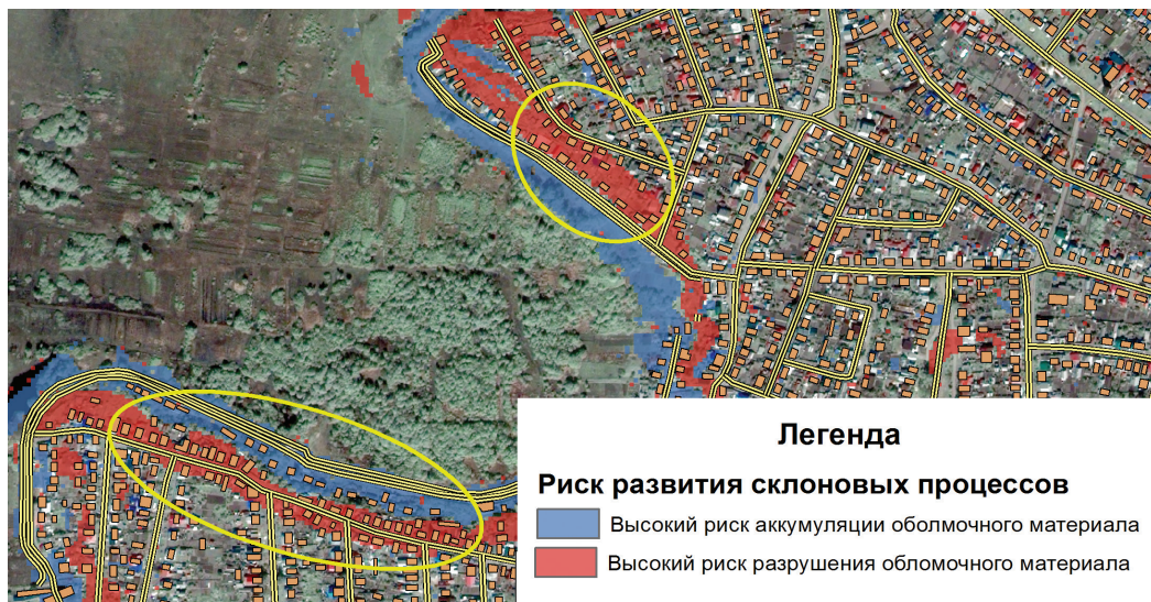
Рис. 2. Моделирование риска развития склоновых процессов в пределах городской территории (желтыми овалами обозначены жилые здания в зонах с высоким риском развития склоновых процессов) на примере г. Борисоглебска Воронежской области
