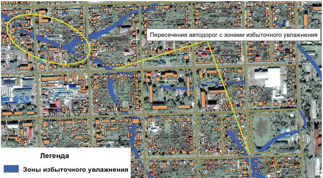
Рис. 3. Выявление жилых массивов и участков автодорог в пределах зон аккумуляции поверхностного стока (на примере г. Борисоглебска Воронежской области)
