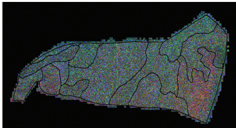
Рис. 2. Векторная карта однородных сегментов радарного цветового композита: даты съемки 11.09, 04.09, 14.09 (VV-поляризация)
