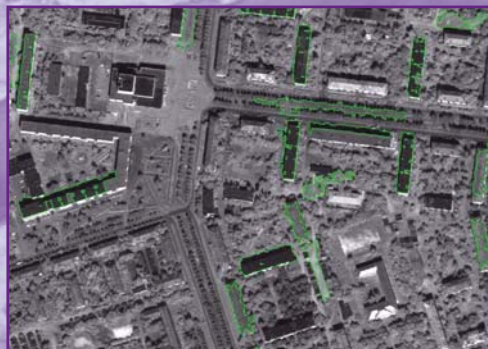
Рис. 16. Пример обработки космического снимка с применением модуля FX для получения контура здания
