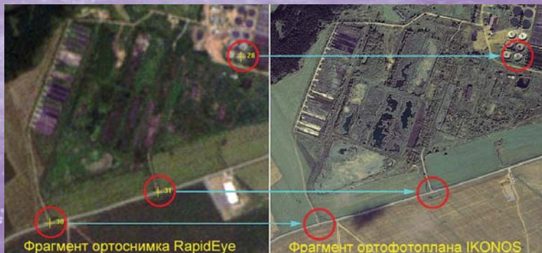
Рис. 1. Определение геодезических координат измеряемых точек на ортоснимке RapidEye по ортофотоплану IKONOS
