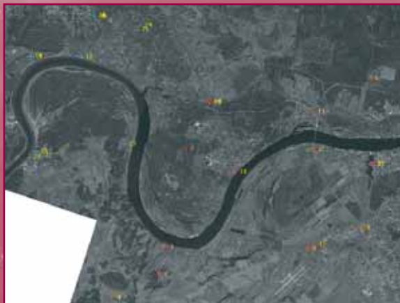
Рис. 7. Расположение контрольных опознаков на ортомозаике (кресты голубого цвета – левый снимок, кресты красного цвета – правый снимок)
