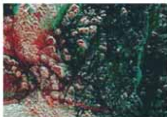
Синтез данных (ERS-1 и Landsat-5). Отражены литологические различия (цвет с Landsat), а также подробная карта структурных линейментов
