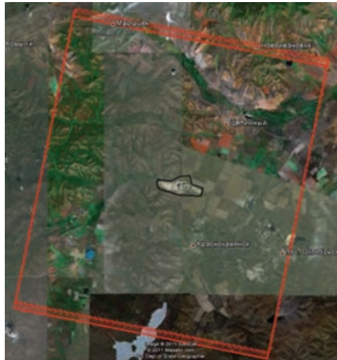
Рис. 1. Схема покрытия территории угольного разреза Уртуйский (черный контур) данными радарных съемок COSMO-SkyMed (красные контуры)
