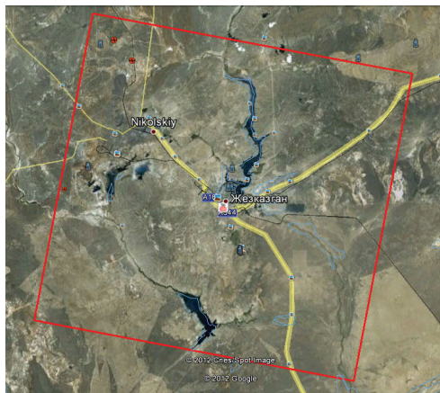
Рис. 2. Схема покрытия территории Жезказганского месторождения данными RADARSAT-2 в режиме съемки Fine (красный контур). Площадь кадра — 50x50 км, пространственное разрешение — 7 м, длина волны радара — 5,5 см
