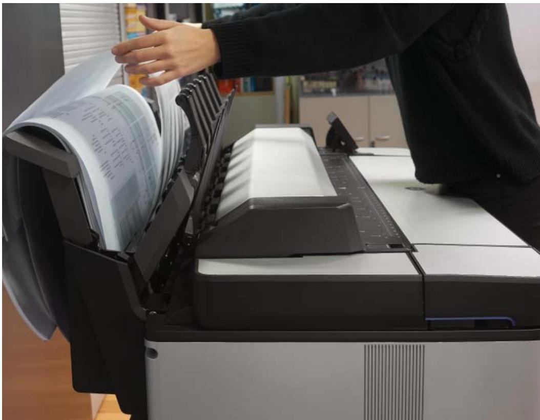
Рис. 2. МФУ HP Designjet T3500 оснащен приемным накопительным лотком, который аккуратно складывают до 100 листов формата А0
