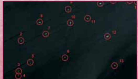
Рис. 7. Пример выявления морских судов на радиолокационном снимке (TerraSAR-X)
