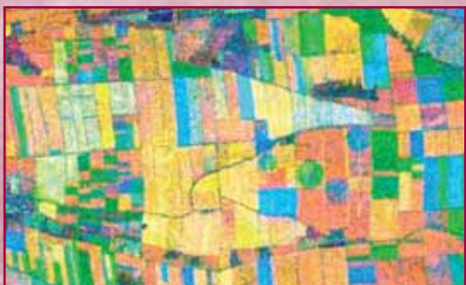
Рис. 5. Мультивременное композитное изображение, демонстрирующее различное состояние сельскохозяйственных угодий (Radarsat-1, разрешение 25 м)
