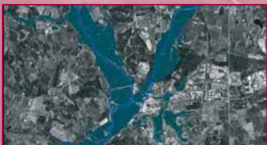
Рис. 4. Карта с выявленными площадями вероятного затопления в результате паводка на основе данных с КА TerraSAR-X
