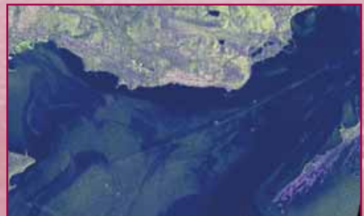
Рис. 2. Радиолокационное поляриметрическое изображение с четкими нефтяными разливами в акватории (TerraSAR-X)
