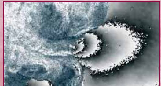
Рис. 8. Композитное изображение с ERS-1 и ERS-2 (амплитуда – суша, фаза – лед), демонстрирующее движение выводного ледника
