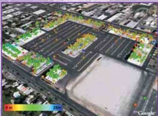
Рис. 1. Иллюстрация методики SAR-tomography, представленная в среде GoogleEarth (цвет точек соответствует высотам объектов на местности)
