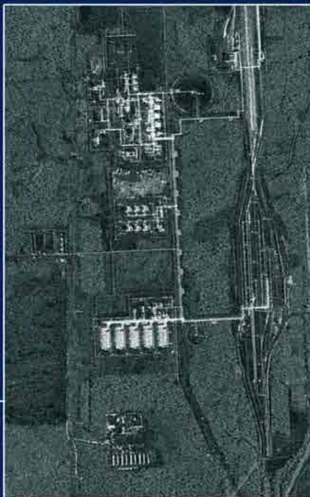
Компрессорная станция. Ямало-Ненецкий АО, Пуровский район. Спутник Terrasar-X. Режим съемки HighSpot (HS), поляризация VV. Амплитудное изображение. Пространственное разрешение – 1 м. 2007г.
