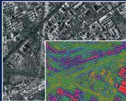
Барселона, Испания. Спутник Terrasar-X. Режим STRIPMAP, поляризация VV. Амплитудное изображение. Пространственное разрешение – 3 м. 2008 г.
