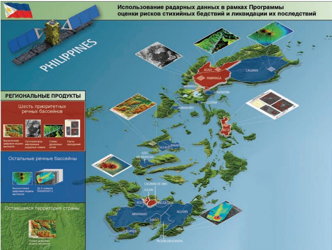
Рис. 1. Компания MDA предоставит набор пространственных данных, включающий ЦМР, ортотрансформированные радарные и оптические снимки, схемы дренажных сетей, карты наводнений
