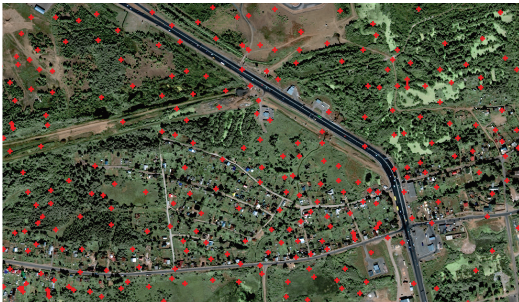
Рис. 4. Схема расположения контрольных точек на эталонном участке 2
