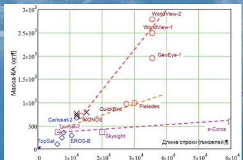
Рис. 4. Увеличение суммарной длины строки фотоприемной аппаратуры и массы КА ДЗЗ высокого разрешения
