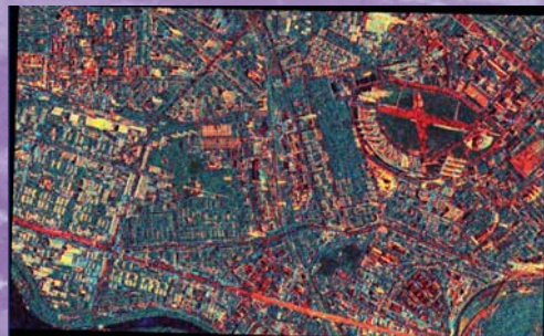
Рис. 4. Геокодированный RGB-композит типа Interferometric Land Use, рассчитанный по двум снимкам TerraSAR-X. Растительность – зеленая, вода – темно синяя, здания – желтые и красные, дороги и поверхности без растительности – красные. Используются функции импорта, расчета когерентности, некогерентного накопления, геокодирования и расчета RGB-композита ILU (Компания «Совзонд», 2010)
