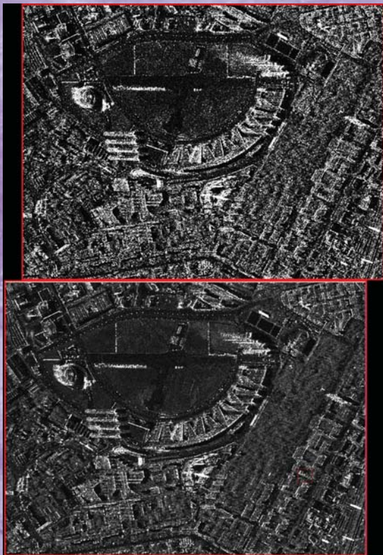
Рис. 3. Исходная (сверху) и фильтрованная мультитременным фильтром (снизу) амплитуда радарного снимка TerraSAR-X. Используются функции импорта, некогерентного накопления, корегистрации и мультитременной фильтрации (Компания «Совзонд», 2010)
