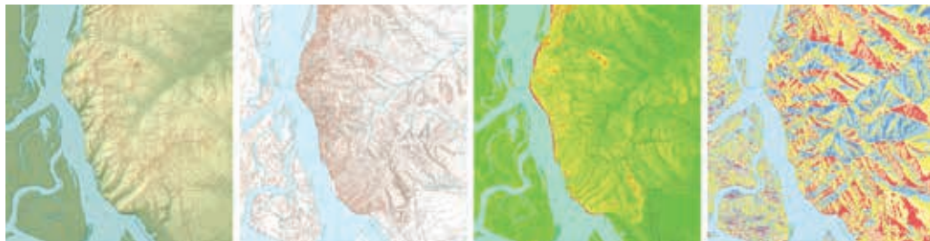
Рис 2. Цифровая модель рельефа местности, слой горизонталей, схема уклонов и схема экспозиций склонов
