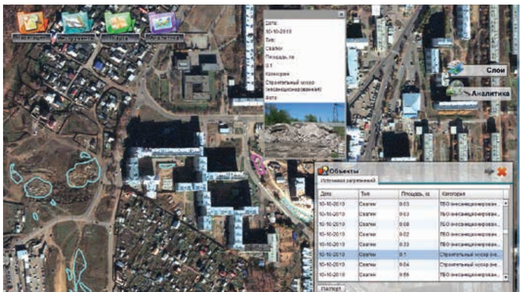
Рис. 5. Геопортал Центра космических технологий ИрГТУ. Выявленная несанкционированная свалка строительного мусора
