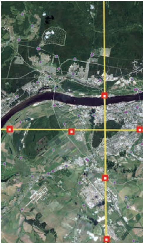
Рис. 7. Пример критического расположения 6 опорных точек на двух перпендикулярных прямых
