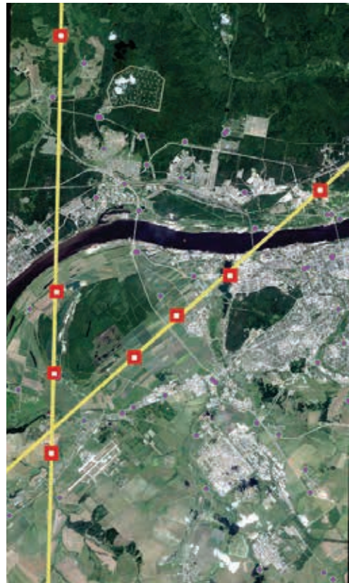
Рис. 8. Пример критического расположения 8 опорных точек на двух произвольных прямых
