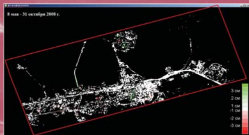
Рис. 13. г. Новый Уренгой. Смещения земной поверхности и деформации зданий и сооружений 31 октября 2008 г.
