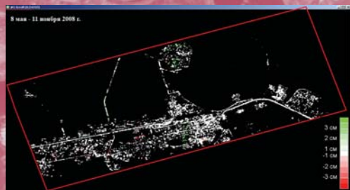
Рис. 14. г. Новый Уренгой. Смещения земной поверхности и деформации зданий и сооружений 11 ноября 2008 г.
