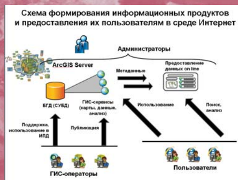
Рис. 3. Схема формирования информационных продуктов и их публикации в сети Интернет с использованием программных средств ArcGIS
