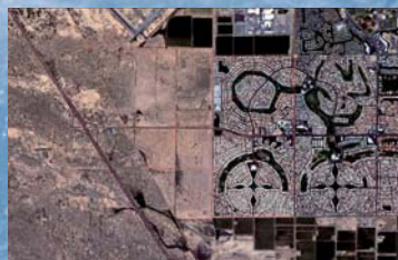
Рис. 4. Ортотрансформированное изображение RapidEye на Феникс в полном разрешении, скорректированное без опорных точек, с наложенными векторами карт USGS масштаба 1:24 000
