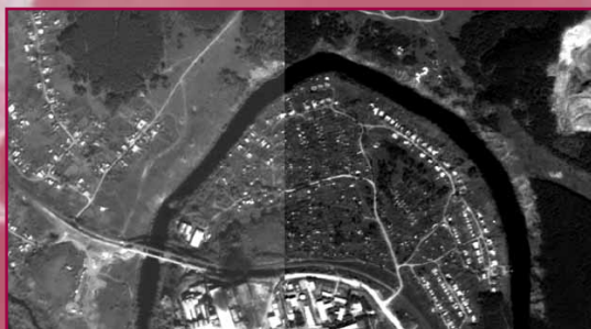
Рис. 4. Согласование контуров на ортотрансформированных снимках ALOS до создания ортомозаики
