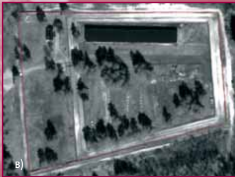
Рис. 4. Расхождения планового положения контуров на ортофотоплане и векторном плане
