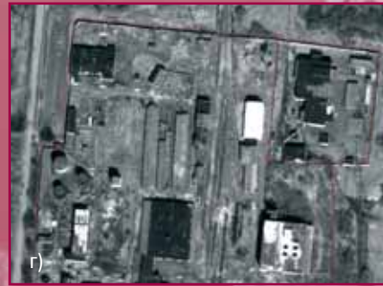
Рис. 4. Расхождения планового положения контуров на ортофотоплане и векторном плане
