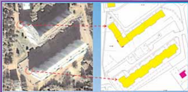
Рис. 2. Пример выбора контрольных точек на ортофотоплане и цифровом топоплане масштаба 1:500
