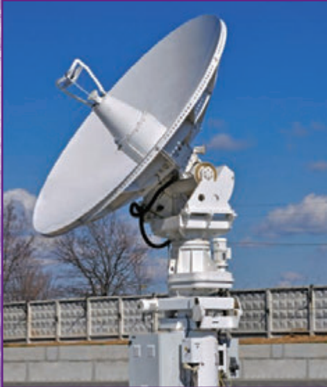
Рис. 3а. Антенно-поворотный комплекс на стандартном 3-хосном опорно-поворотном устройстве
