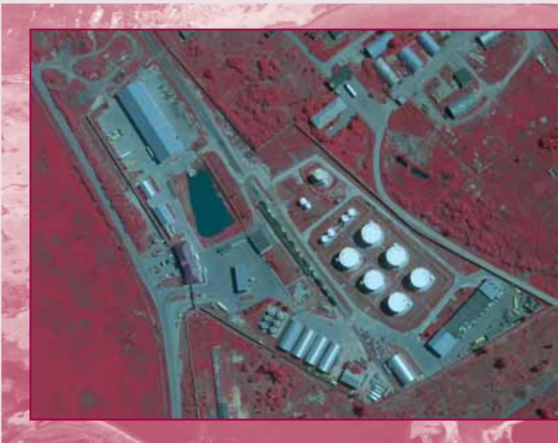
Рис. 1. Отображение РВС (резервуары вертикальные стальные) в натуральных цветах (разрешение 0,1 м)
