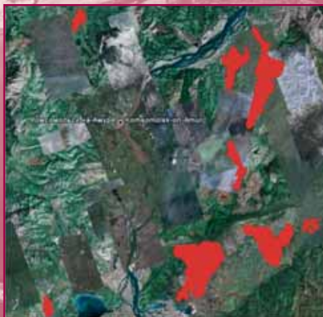
Рис. 2. Границы прогнозируемых месторождений углеводородов по данным квантово-оптической фильтрации космоснимка части территории Дальнего Востока
