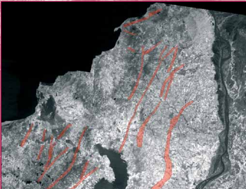
Рис. 5. Схема отражения разрывных нарушений на тепловом космическом снимке
