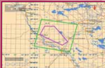
Рис. 1. Схема покрытия месторождения Кандым архивными данными Envisat/ASAR
