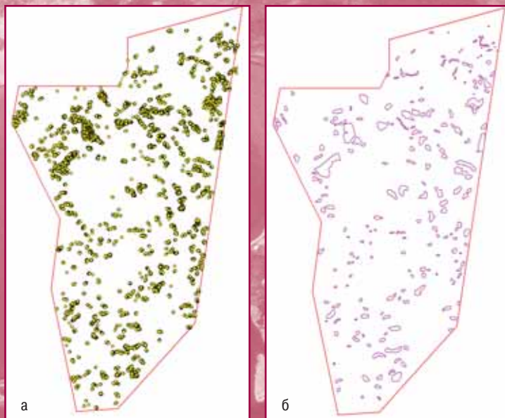
Рис. 5. а) распределение термокарстовых просадок; б) зоны активного развития термокарстовых форм
