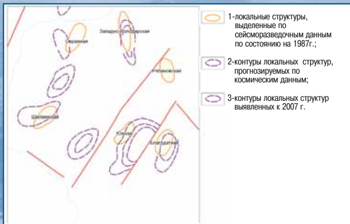
Рис. 3. Фрагмент карты-схемы сопоставления локальных структур, спрогнозированных по космическим и выявленным по результатам поисковых работ, Жигулевско-Пугачевского свода Волго-Уральской нефтегазоносной провинции.
