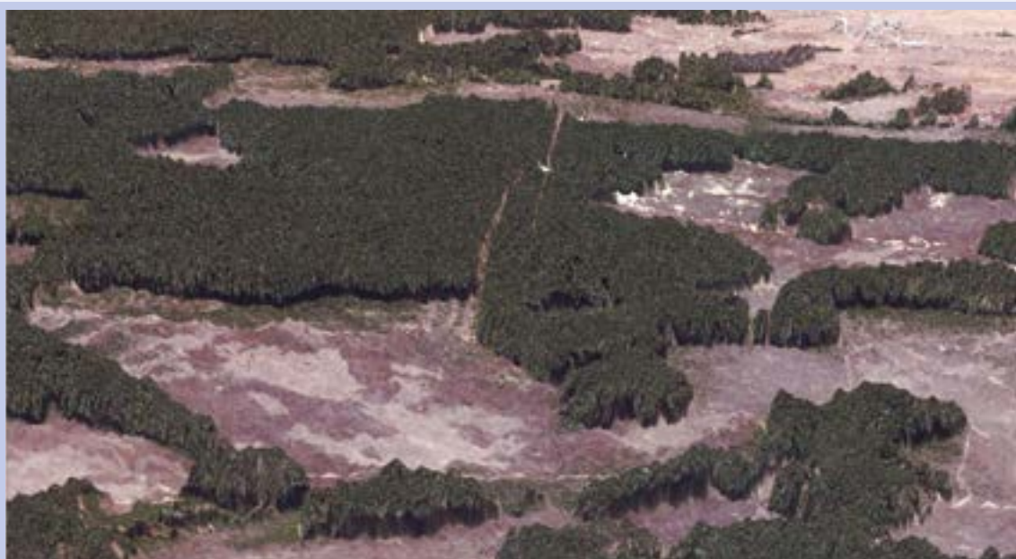
Трехмерное отображение карты высот деревьев, полученной по данным радарной тандемной интерферометрии
