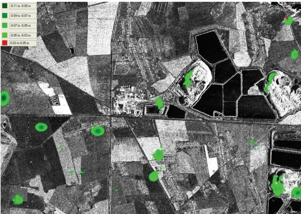
Рис. 16. Просадки земной поверхности, совмещенные с радиолокационным снимком COSMO-SkyMed
