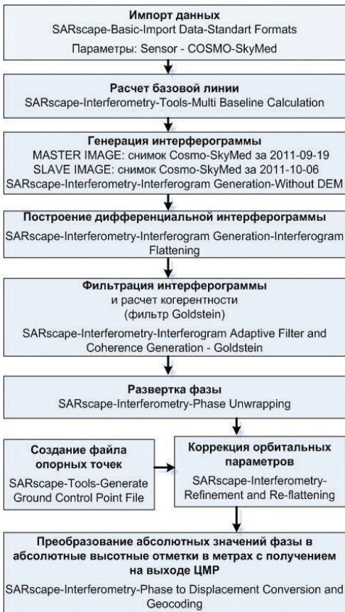
Рис. 4. Технология построения цифровой модели рельефа по радиолокационным данным в программе ENVI+ SARscape
