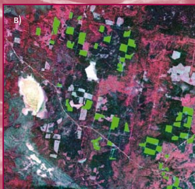
Рис. 7. а. Снимок IRS/LISS III, 2007 г., приведенное разрешение 5 м б. Снимок RapidEye, 2010 г., разрешение 5 м в. Автоматически полученные полигоны изменений
