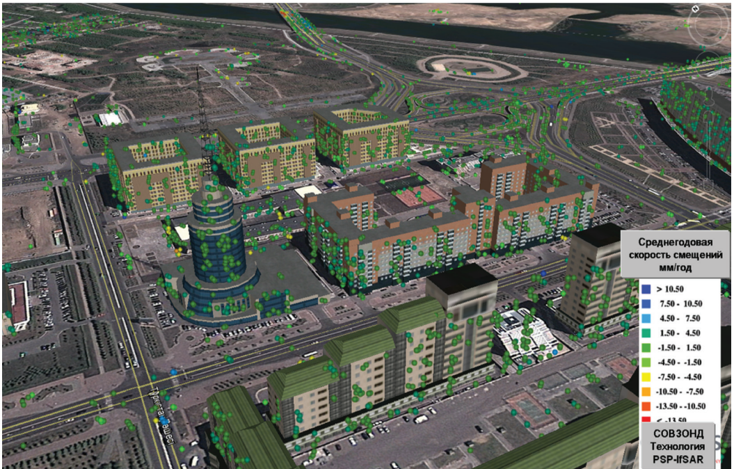
Рис. 14. Стабильные здания ЖК «Нурсая 1» (на переднем плане), бизнес-центр «Астаналы» и ЖК «Новый мир» (по центру), ЖК «Арайлым», «Премиум» и «Версаль» (на заднем плане). Также стабильные рассеиватели на дорожной развязке ул. Орынбор и Сарайшык
