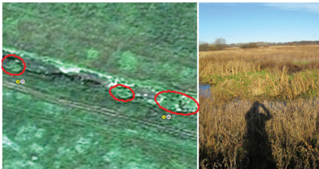
Рис. 8. Зарастание макрофитами канала 6-ОГД (слева — космический снимок GeoEye-1, справа — фото 2014 г.)
