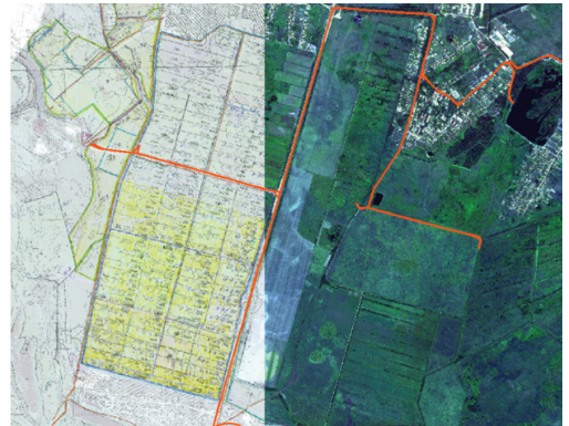
Рис. 4. Геопривязка схемы мелиоративных систем в ПО ArcGIS (красными линиями обозначены GPS-треки полевых маршрутов)
