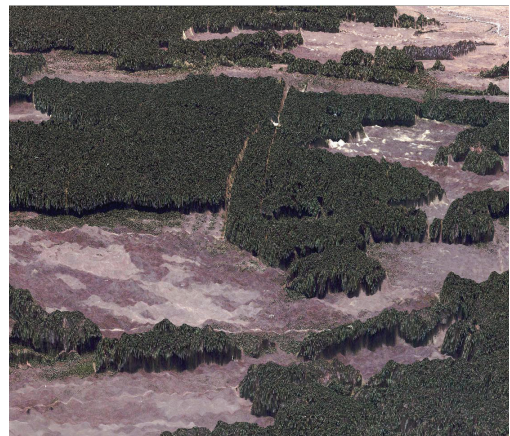
Рис. 8. Псевдоцветовое трехмерное отображение фрагмента цифровой модели средней высоты деревьев, полученной по тандемной паре радарных снимков TerraSAR-X/TanDEM-X от 18.02.2012 г., с наложением на нее оптического снимка
