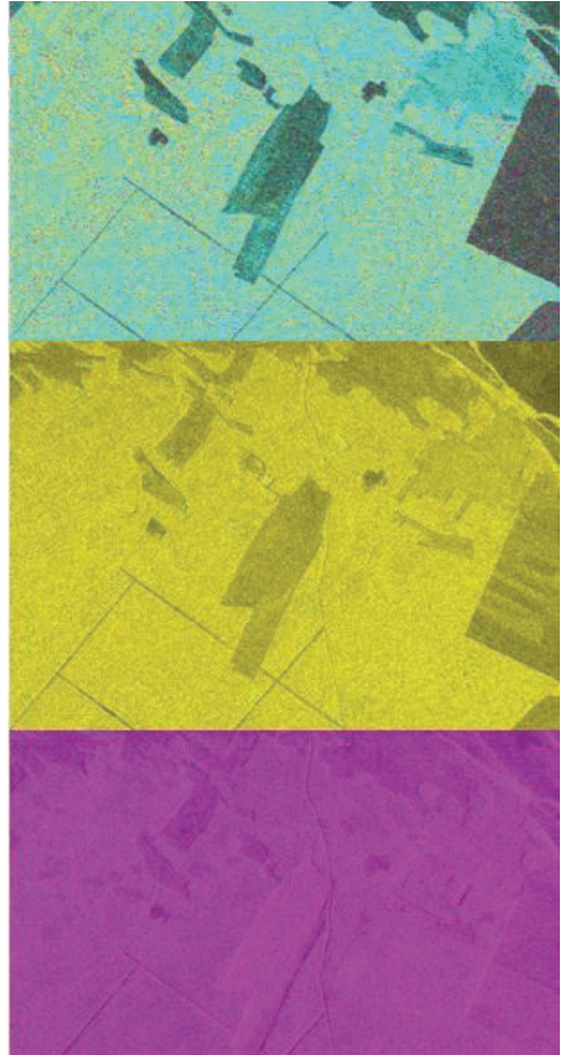
Рис. 5. Фрагменты дифференциальных интерферограмм тандемных пар снимков TerraSAR-X/TanDEM-X от 25.05.2013 г. (снизу) и 18.02.2012 г. (по центру), а также одной пары снимков с повторных витков орбиты ALOS PALSAR (сверху)
