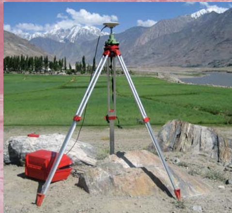
Рис. 1. Измерение координат точек 1-го класса методом GPS
