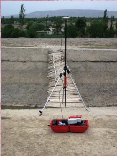
Рис. 2. Определение координат наземных опорных точек с помощью GPS
