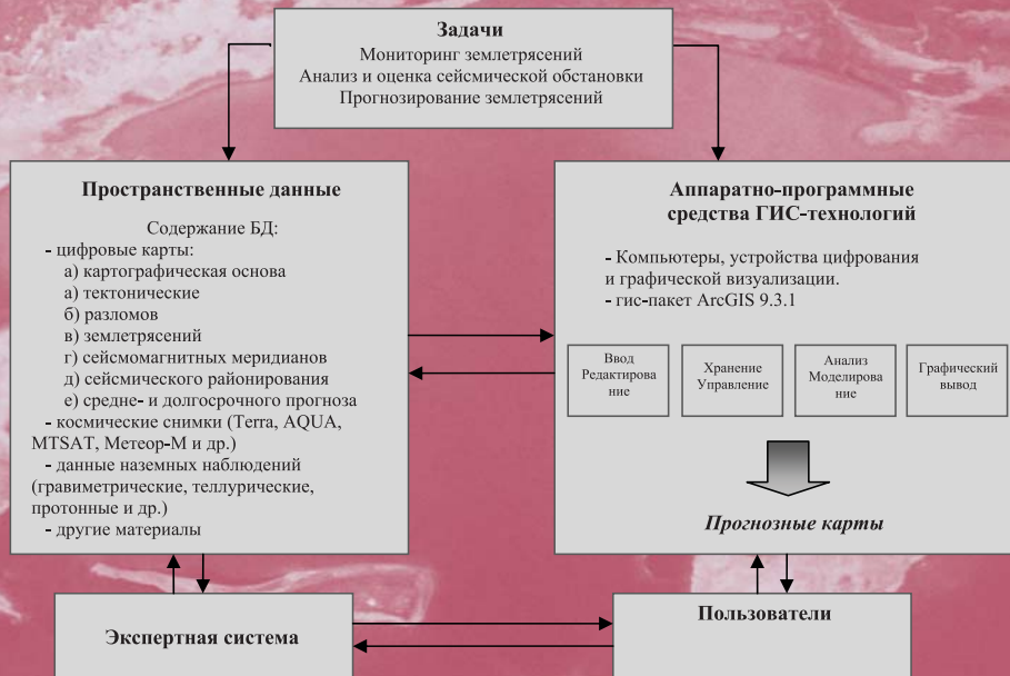
Рис.1. Структурная схема ГИС для решения задач мониторинга и прогноза землетрясений
