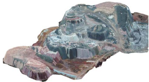
Рис. 2. Трехмерная модель отвалов рудника Космурун
