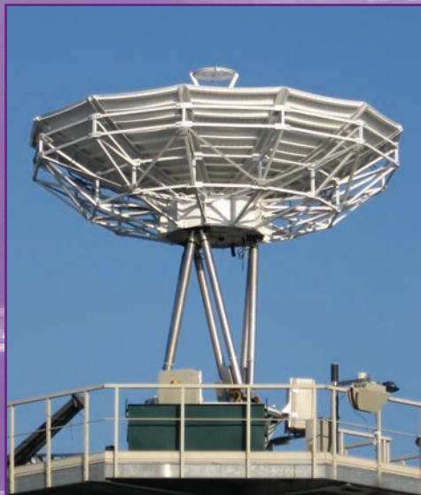
Рис. 3б. Антенно-поворотный комплекс на основе 6-опорной конструкции (Гексапод)
