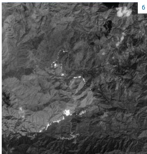
Рис. 3. Спутник WorldView-3. Электромагнитные волны в длинноволновом инфракрасном диапазоне способны проникать через дым пожара и туман: а) снимок в натуральных цветах (справа вверху — облако, слева внизу — дым); б) снимок с сенсора SWIR (виден только след от облака и очаг пожара)
