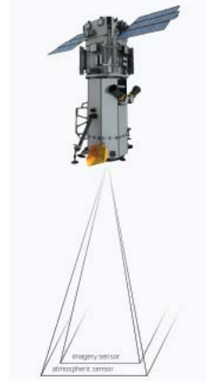
Рис. 1. Ширина полосы съемки сенсора для атмосферной коррекции спутника WorldView-3 больше, чем ширина полосы съемочной аппаратуры
