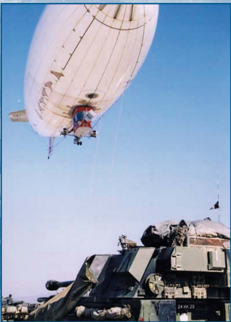
Рис. 6. PCA Mineseeker использовался объединенными войсками KFOR в Косово
