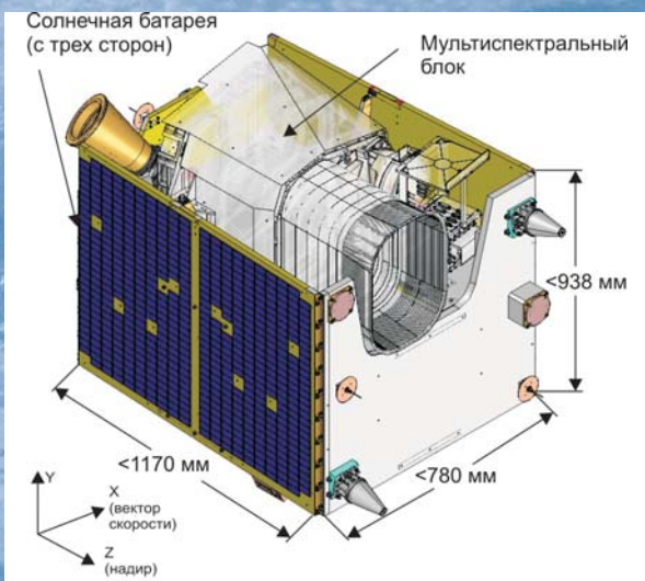
Рис. 1. Схема спутника RapidEye
