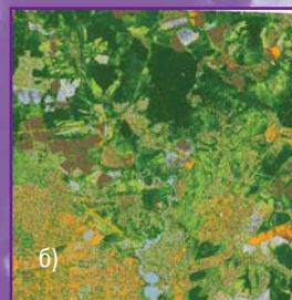
Рис. 3. Результат расчета индекса NDVI: а) индексное изображение в полутоновом варианте; б) индексное изображение, раскрашенное в псевдоцвета
