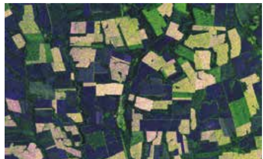
Рис. 4. Образец обработанного снимка Sentinel-1. Дата съемки 20.07.2015 г. Композитное RGB-изображение: R — интенсивность сигнала в поляризации VV; G — интенсивность сигнала в поляризации VH; B — частное от деления интенсивности в поляризации VV на интенсивность в поляризации VH.
