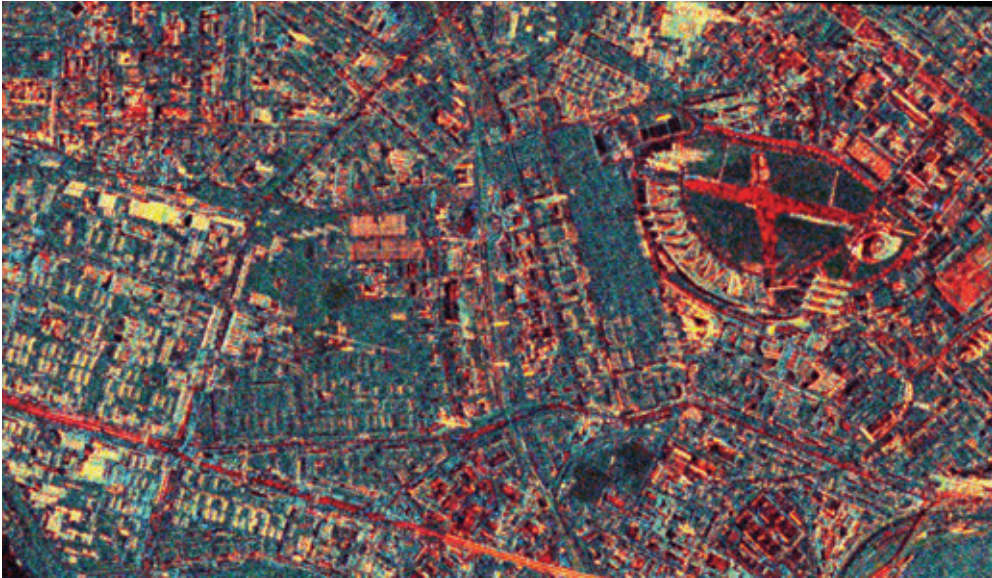
Рис. 10. Геокодированный RGB-композит muна Interferometric Land Use , рассчитанный по двум снимкам TerraSAR-X (Infoterra GmbH). Растительность зеленая, вода темно-синяя, здания желтые и красные, дороги и поверхности без растительности красные; использованы функции импорта, расчета когерентности, некогерентного накопления, геокодирования и расчета RGB-композита ILU (Компания «Совзонд», 2012 г.)
