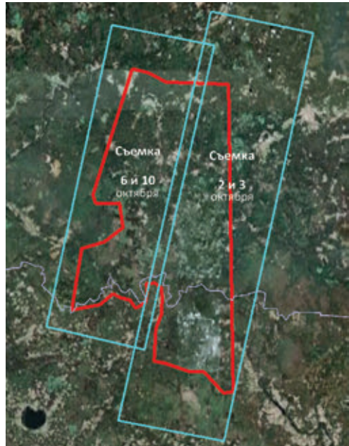
Рис. 1. Схема съемки территории Бабушкинского лесничества (красный контур) со спутников COSMO-SkyMed (голубые контура — полосы съемки)
