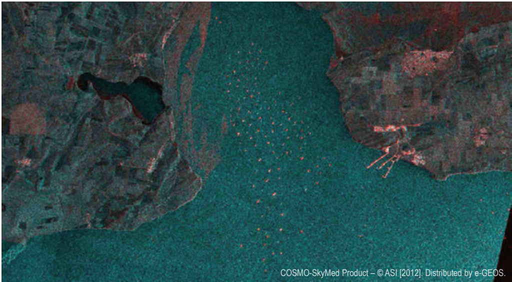
Рис. 7. Фрагмент мультивременного амплитудного композита. Корабли, ожидающие проводки через замерзший Керченский пролив. Белые яркие точки — корабли, стоящие на одном и том же месте и 11, и 17 февраля. Красные точки — корабли, присутствующие на снимке от 11 февраля, но отсутствующие на снимке от 17 февраля. Голубые точки — корабли, отсутствующие 11 февраля и появившиеся 17 февраля
