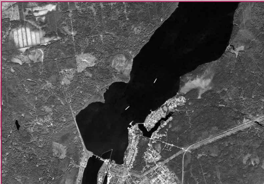
Рис. 1. Ортотрансформированная мозаика ОРТОРЕГИОН на нижний бьеф Нижнесвирского водохранилища (Ленинградская область; изображение уменьшено в 4 раза)
