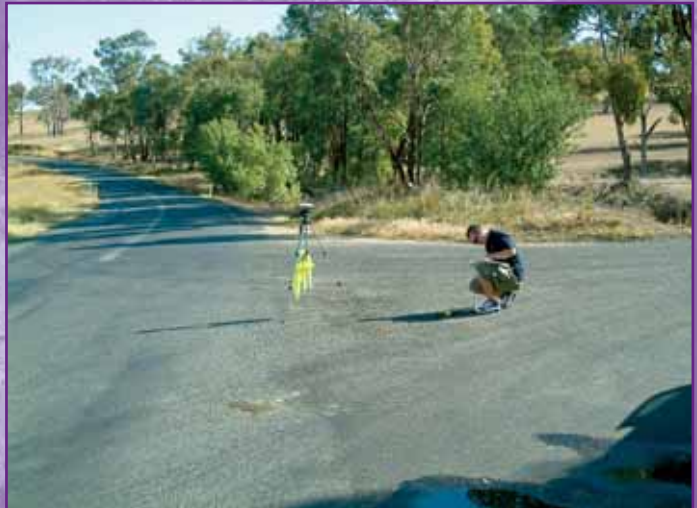
Рис. 6. Фотография наземной опорной точки № 15
