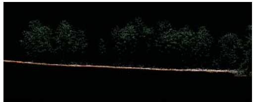
Рис. 3. Профиль (по красной линии на рис. 2). Хорошо видно различие кроны каждого дерева и поверхность рельефа под кронами
