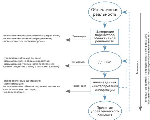
Рис. 1. Структурная схема полной функции анализа данных и основные тенденции развития ГИС на ее стадиях
