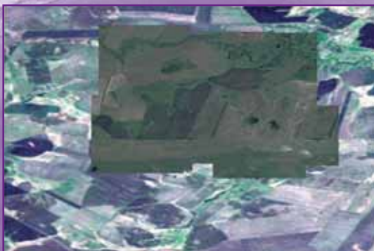
Рис. 1. Наложение снимка из архива DigitalGlobe (полученного с использованием сервиса ImageConnect) на снимок с КА Landsat
