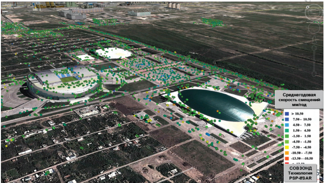
Рис. 17. Стабильные рассеиватели на зданиях ледового дворца «Алау» (справа), футбольного стадиона «Астана арена» (слева) и велотрека «Сары-Арка» (задний план)
