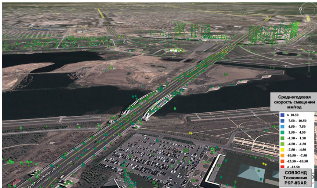
Рис. 16. Стабильные рассеиватели на мосту по ул. Сарайшык (по центру) и на зданиях на заднем плане
