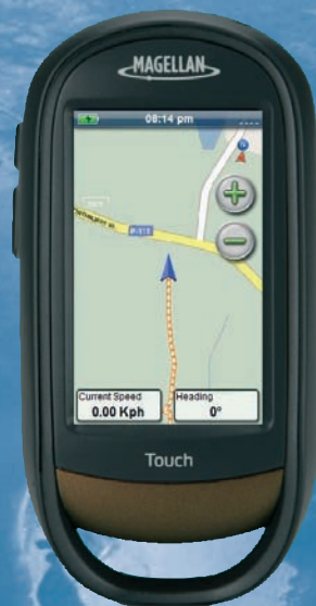
Рис. 5. GPS-навигатор Magellan Touch.
