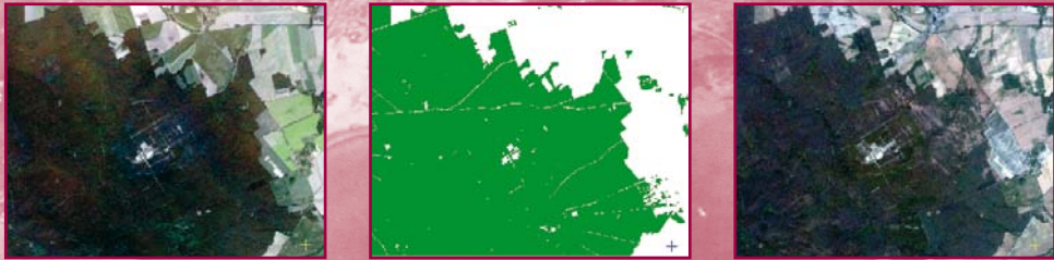
Рис. 9. а. снимок RapidEye, 25 августа 2009 г. б. маска леса в. снимок RapidEye, 5 июня 2010 г.
