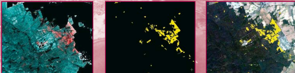
Рис. 10. а. выделение основного компонента по двум снимкам RapidEye б. результат обработки в. совмещение выделенных полигонов со вторым снимком
