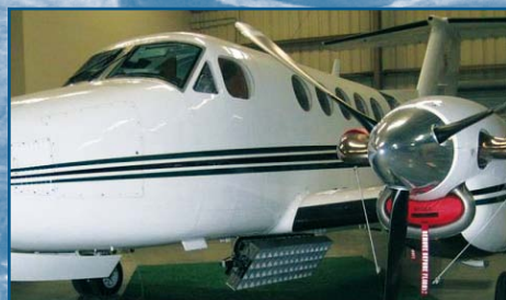
Рис. 3. Пример реализации РСА FOPEN SAR на борту самолета
