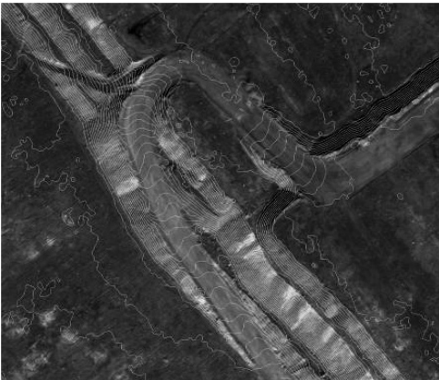
Рис. 2. Составление горизонталей по космическому стереоснимку
