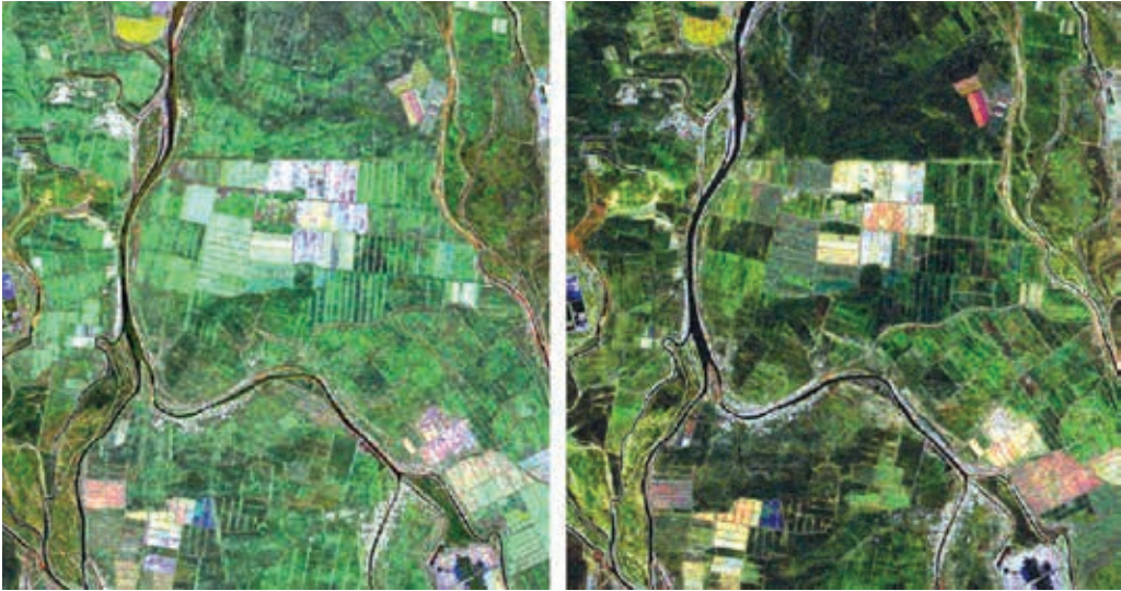
Рис. 3. Фрагмент RGB-синтезированного многовременного снимка (R — 11 сентября, G — 5 октября, B — 29 октября): левый — VV-поляризация, правый — VH-поляризация
