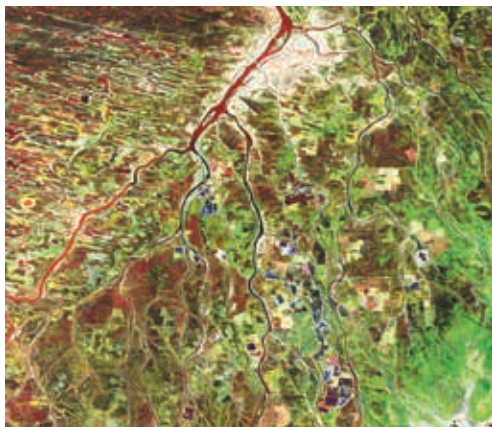
Рис. 2. Радиолокационное RGB-синтезированное изображение, компоненты: R — снимок 11 сентября, VV поляризация; G — 5 октября, VH-поляризация; B — 29 октября, VH-поляризация
