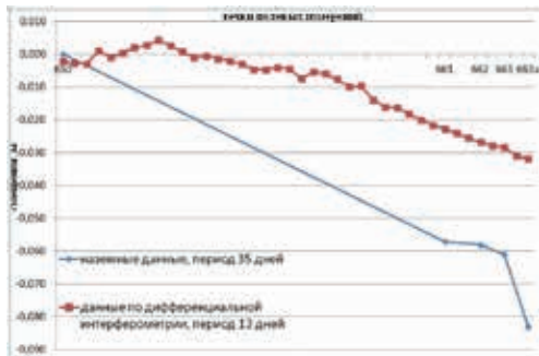
Рис. 12. Профиль смещений, отражающий вертикальные движения земной поверхности по данным дифференциальной интерферометрии и полевым данным
