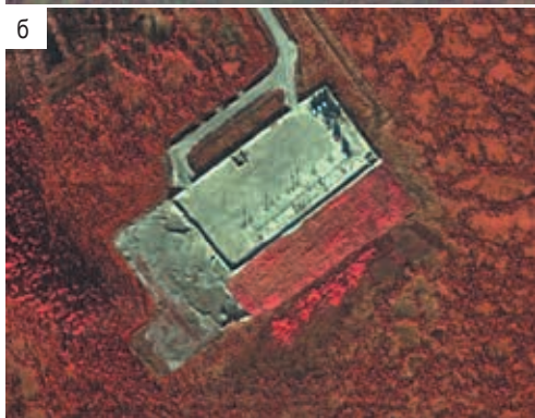
Рис. 2. Состояние бурового шламового амбара на синтезированных космических снимках сверхвысокого разрешения за период 2008–2011 гг.: а – нерекультивированный; б – рекультивированный
