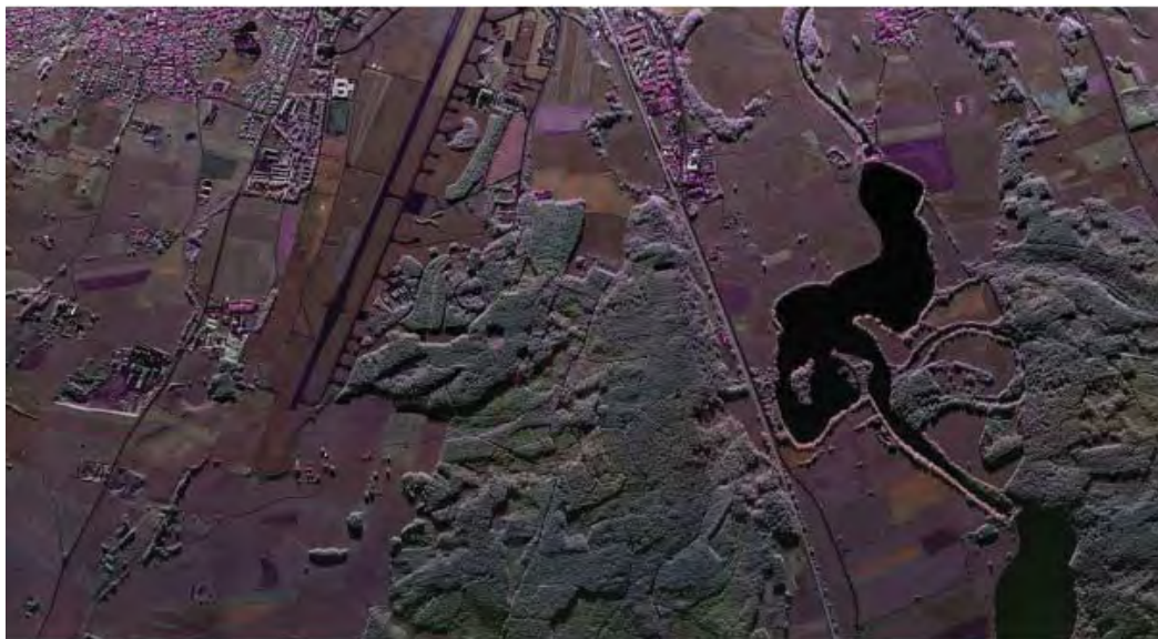
Рис. Симуляция 4-поляризованного цветного изображения с разрешением 25 см (получено с помощью радарной авиационной съемки)
