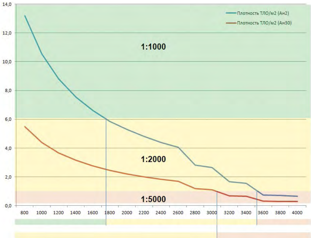
Рис. 6. Плотность точек лазерного сканирования, получаемая с использованием камеры Riegl Q1560 на различных носителях. Ось X — высота в м, ось Y — количество точек на 1 кв. м
